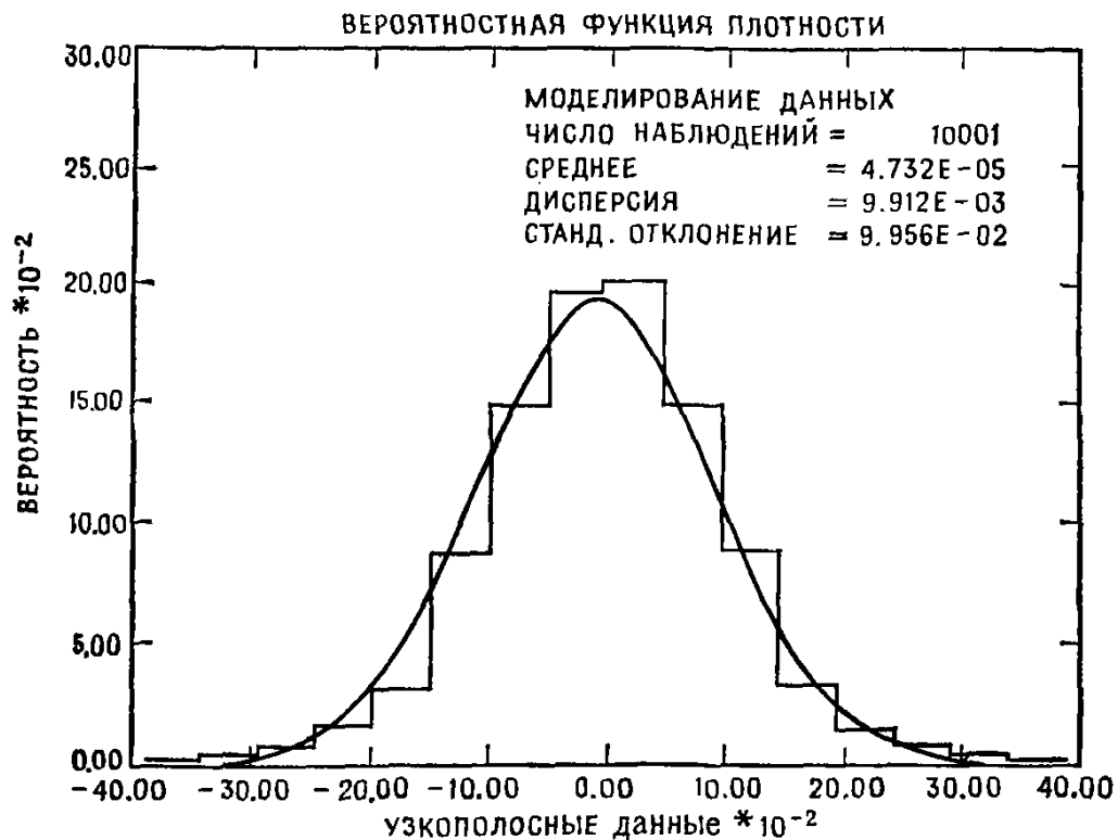
Рис. 2.8. Выборочная функция плотности для большого участка процесса, полученного узкополосной фильтрацией. Сюда включены данные, полученные для рис. 2.7.
